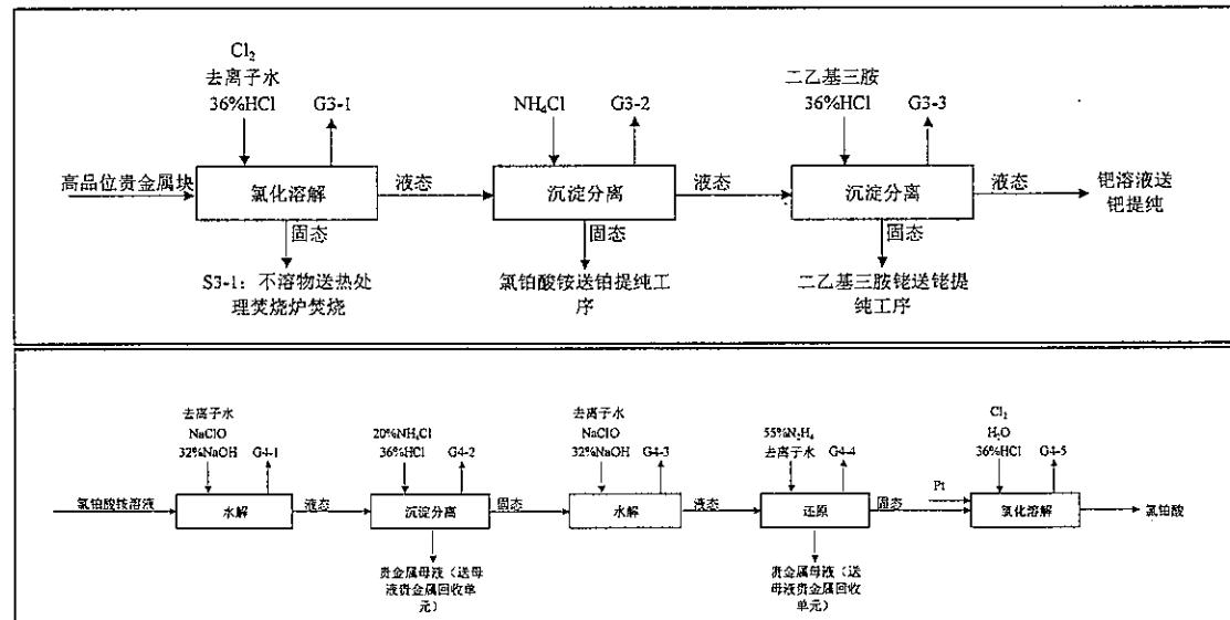
3.3 铂的精炼生产：氯铂酸滤液进入反应釜，在氯酸钠和盐酸的作用下，从 2 价氧化成 4 价，再和氯化铵反应生成氯铂酸铵（红色的盐）沉淀。溶液冷却后过滤，滤液送母液贵金属回收单元，红色的盐转移到下一步溶解工序；氯铂酸铵沉淀中加入去离子水，形成氯化铂。加热至沸腾，促进红色的盐溶解。再加入氨水及氢氧化钠溶液，反应生成二氯四氨铂溶液；二氯四氨铂中加入盐酸生成二
