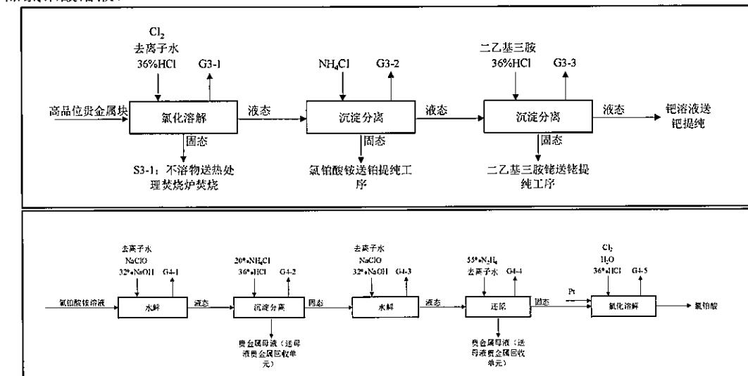
3.3 钯的精炼生产：氯钯酸滤液进入反应釜，在氯酸钠和盐酸的作用下，从 2 价氧化成 4 价，再和氯化铵反应生成氯钯酸铵（红色的盐）沉淀。溶液冷却后过滤，滤液送母液贵金属回收单元，红色的盐转移到下一步溶解工序；氯钯酸铵沉淀中加入去离子水，形成氯化钯。加热至沸腾，促进红色的盐溶解。再加入氨水及氢氧化钠溶液，反应生成二氯四氨钯溶液；二氯四氨钯中加入盐酸生成二氯二氨
